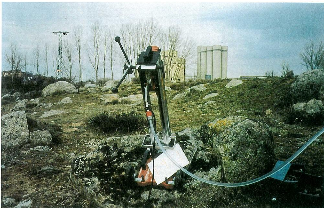
Máquina extrayendo muestras de una tolmera de granito para el estudio litológico. (Fotografía extraída del estudio de la piedra efectuado por GEOCISA).
