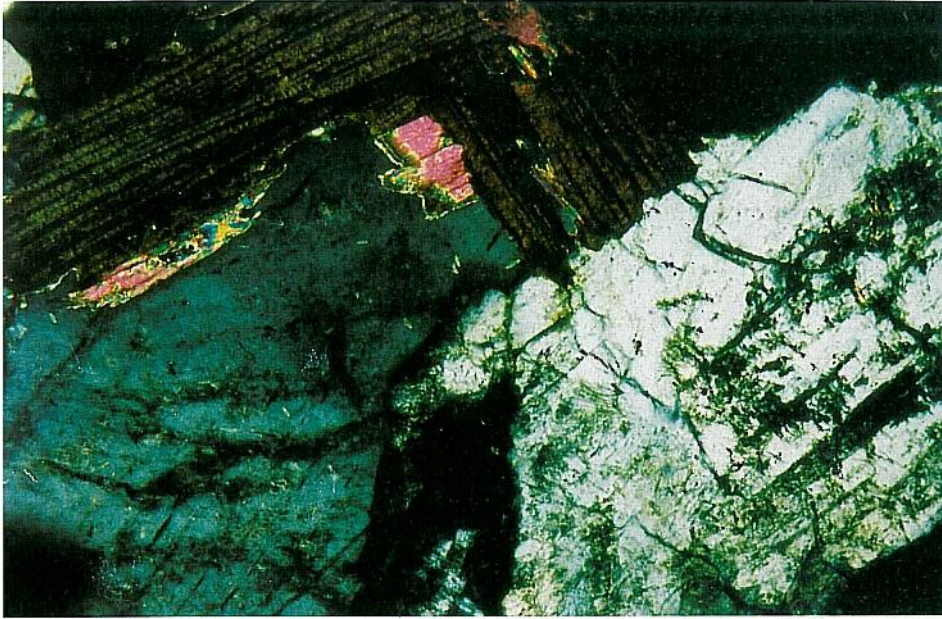
Microfotografía de granito extraído del Acueducto. Se observa cristal de plagioclasa alterado y fisurado, feldespatos potásicos con menor grado de alteración, biotita y moscovita. (Fotografía extraída del estudio de la piedra efectuado por GEOCISA).
